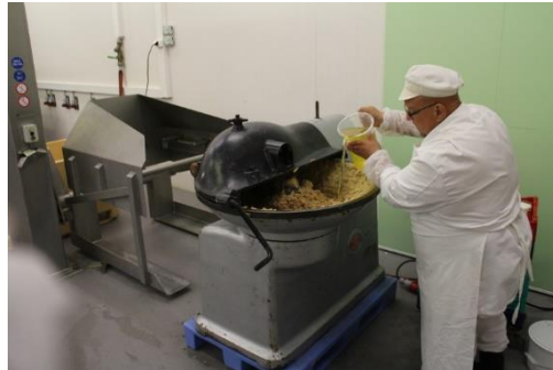
Vaihe 2. Lahnamassan kutterointi
