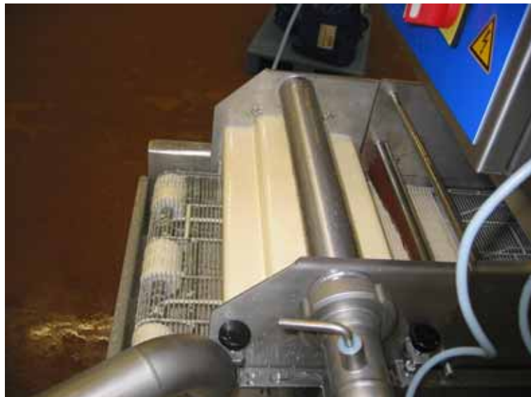
Kuva 337 Koneen alkupää jossa tuote ajetaan tartunta-aineen lävitse
