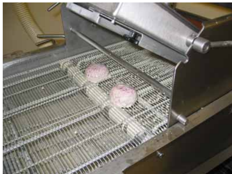
Kuva 338 Tartunta-aine tuotteen pinnassa.
